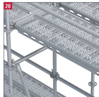
20 Auskragungen 0,5m unter der Belagebene mit Konsolstreben oder Allround Diagonalen abstützen. Gerüstböden auf Konsolverbreiterungen und Auskragungen mit entsprechender Bodensicherung gegen unbeabsichtigtes Ausheben sichern.
