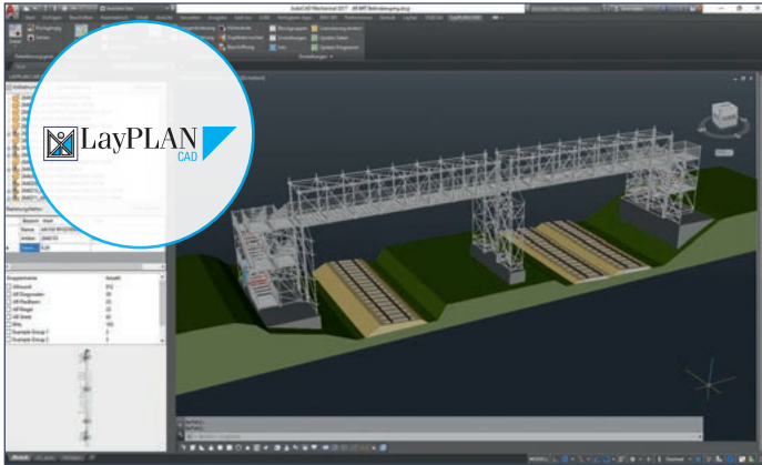
Planung von individuellen Gerüstkonstruktionen in LayPLAN CAD
